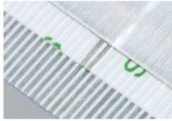
geschimtes FFC-Kabel mit kontaktiertem Schirm
